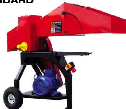
RE serie ist mit einem 4 kW/7,5kW 3-Phasen-Induktions-Elektromotor ausgestattet.
