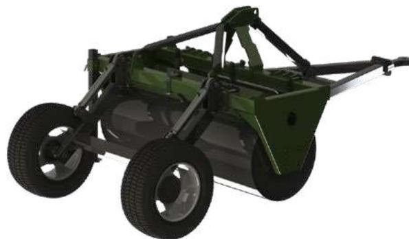
Anhängung der Kategorie 1/2, Walzendurchmesser 600 mm, Auffüllung mit Wasser möglich, Arbeitsbreite: 1600mm, zwei Walzenabstreifer, Anbaumöglichkeit: vordere und hintere Dreipunktaufhängung
