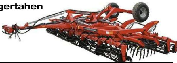
Standardausstattung: 5 Reihen von Federzinken (19Stück/m) mit einer stufenlos einstellbaren Arbeitstiefe von 0-10cm, Segmentstruktur Ssegmentowa budowa; hydraulischer Druck jeder Sektion (sektion je 1 m); vordere Flachstabwalze Ø320 mm; hintere Flachstabwalze Ø320 mm; finisch Walze Ø260mm mit Gummisicherung; Ausgleichegge mit arbeitshöhe regulation mit gummisicherung; transportwagen mit Deichsel,
