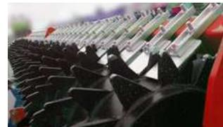
**Crosskillwalze KSE-WCR.** Dank dem geringen Strichabstand sowie speziellem Scheibenprofil, eignet diese sich besonders gut für mittlere und schwere Böden. Sie gewährt gute Verfestigung, Einebnung und Krümelung des Bodens bei geringem Risiko, sich zu bekleben. Die Crosskillwalze hinterlässt eine dünne Schicht des gekrümelten Bodens und verhindert dadurch die Austrocknung dessen tieferen Schichten. Die Walze eignet sich nicht für feuchte Böden.
