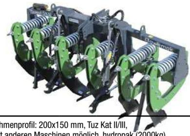
Rahmenprofil: 200x150 mm, Tuz Kat II/III, Verbindung mit anderen Maschinen möglich, hydropak (2000kg)
