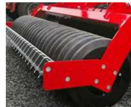
**T-Ringwalze KSE-WT.** 500mm bzw. 600mm mit Abstreifer für beste Rückverfestigung und Spurführung. Durch diese Walze wird eine ruhige und spurtreue Maschinenführung erzeugt. Erfunden zum aggressiven Zerschlagen von Erdkluten und Strohrückständen. Auf Lehmböden wird idealerweise ein raues Bodenprofil geschaffen.
