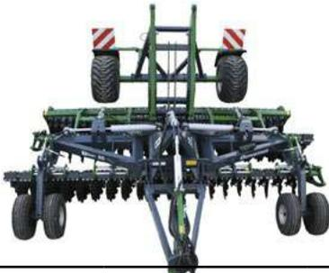
Zweischeibenreihen Ø560mm PREMIUM, aktive Seitenbleche, Rohrstabwalze Ø 600, Rohrstabwalze Ø 600, Scheibenreihenabstand 100 cm, Gummisicherung Ø43x210mm, wartungsfreie Lager NSK/FKL, wartungsfreie Lager der Walzen UCF210, Rahmenprofile 180x180
