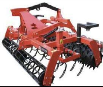
2 Federzinkenreihen 32x12mm mit einer stufenlos einstellbaren Arbeitstiefe 0-15cm, vordere Flachstabwalze Ø320mm, Hydropak mit 2 Zylindern, Hitch für den Anbau einer Sähmaschine.
