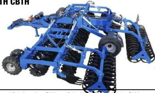
zwei Scheibenreihen Ø620mm, Seitenbleche, Rohrstabwalze Ø600, Scheibenreihenabstand 105cm, Fahrwerk, Beleuchtung, Druckluftbremsen, hydraulische Arbeitstiefenregulation, Gummisicherung Ø50x210mm, Wartungsfreie Lager NSK, Stützräder
