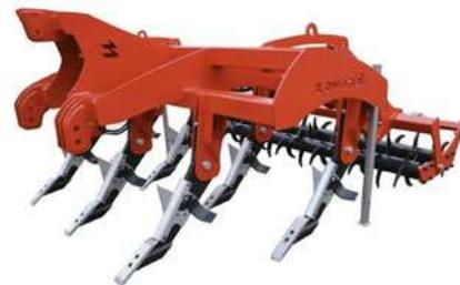
Rahmenprofil 120x120x10, wechselbare Arbeitselemente, Schraubensicherung, hydraulische Arbeitstiefeneinstellung (max. 65 cm), Arbeitselemente aus Bohrstal, Rahmenhöhe 92 cm, Reihenabstand 90cm, Stachel-doppelwalze.
