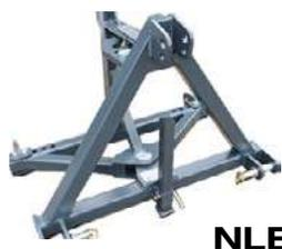
Nachlaufeinrichtung für nahezu spurgetreues Nachlaufen des Reitplatzplaners hinter dem Schlepper.
