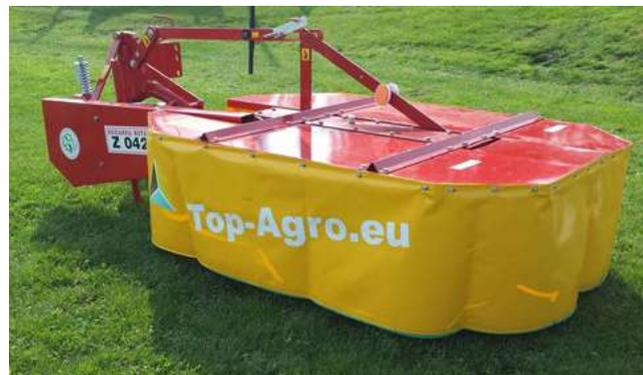
Top-Agro Kreiselmäher, die für das Schneiden von allen grünen Pflanzen auf Wiesen und Feldern geeignet sind und somit sowohl für Klein- als auch Großbetriebe geeignet sind. Der Einsatz von schnell rotierenden Scheiben ermöglicht eine hochwertige und effiziente Schneidleistung.
