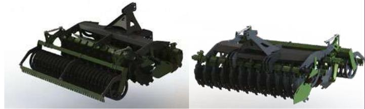
Zwei Scheibenreihen, Seitenbleche, Stützräder R15/200, Scheibenabstand 85cm, Rohrstabwalze 500
