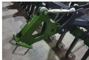
Stufenlose Schraubverstellung der Arbeitstiefe
