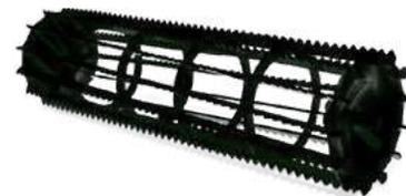
**U-Ringwalze** ist für alle Bodentypen. Dank dem U-Profil weist Sie gute krümelnde Wirkung auf und setzt sich mit dem Boden wenig zu. Um eine gute Mulchqualität mit einem hohen Rückverfestigungseffekt zur Aussaat zu erreichen, ist die U-Ringwalze zu wählen. Zwischen den Ringen wird ein Abstreifer montiert, der die Walze vor der Verstopfung schützt.
